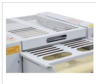
Proteção móvel intertravada com parada imediata.
