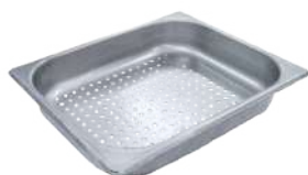
Cuba GN de 1/2, confeccionada em aço inoxidável 304 com fundo perfurado (GN 1/2 P - 325x265x65mm)
